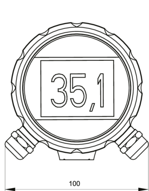
Корпус FlexHousing, поставляется с сенсорным экраном DFON или без него
